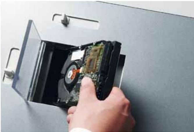
**BOCA DE ENTRADA DE ALIMENTACIÓN AJUSTABLE** Una cómoda palanca ajusta la boca de entrada de alimentación fácilmente a los dos tamaños de discos duros más comunes (3,5" y/o 2,5").
