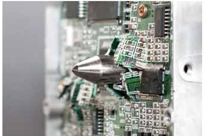
**EL RESULTADO** Haciendo un agujero a través de todo el disco duro, todos los componentes (caja de metal, disco y demás partes electrónicas) quedan dañados irreparablemente y los datos resultan inaccesibles.
